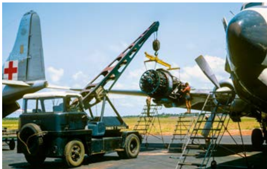
Mit einem vom Militär ausgeliehenen Kran erfolgten so in Cotonou die Motorenwechsel unter freiem Himmel, hier an einer DC-6A/B.
