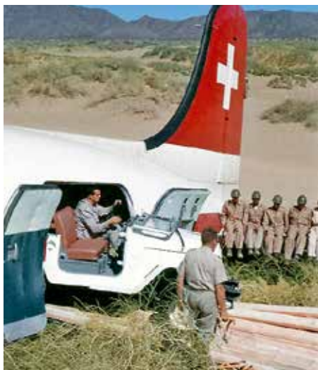
Links: Um das «Absitzen» der DC-4 sicher zu gestalten, mussten Soldaten auf das Höhenleitwerk sitzen. Dann wurde mit langen Brettern eine Rampe gebaut und der Geländewagen aus dem Flugzeugrumpf herausgefahren. Mitte: Probestart der HB-ILB ohne Passagiere und spezielle Beladung. Rechts: Patienten-Aufnahmestation des Notspitals von Najran.
